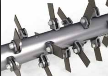
Vertikutier - Rotor mit pendelnd aufgehängten Messern, einfach und schnell zu wechseln.
