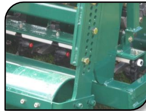
Gemakkelijk in te stellen diepte verstelling d.m.v. bouten
